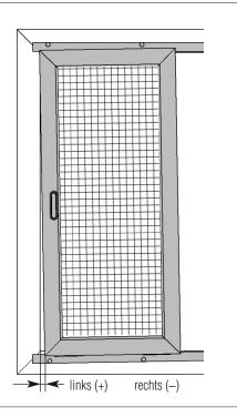
Durch Verschieben des Kunststoffrollenhalters in die ( — ) Richtung, wandert der Schiebeflügel auf dieser Seite um 1 mm nach unten.
