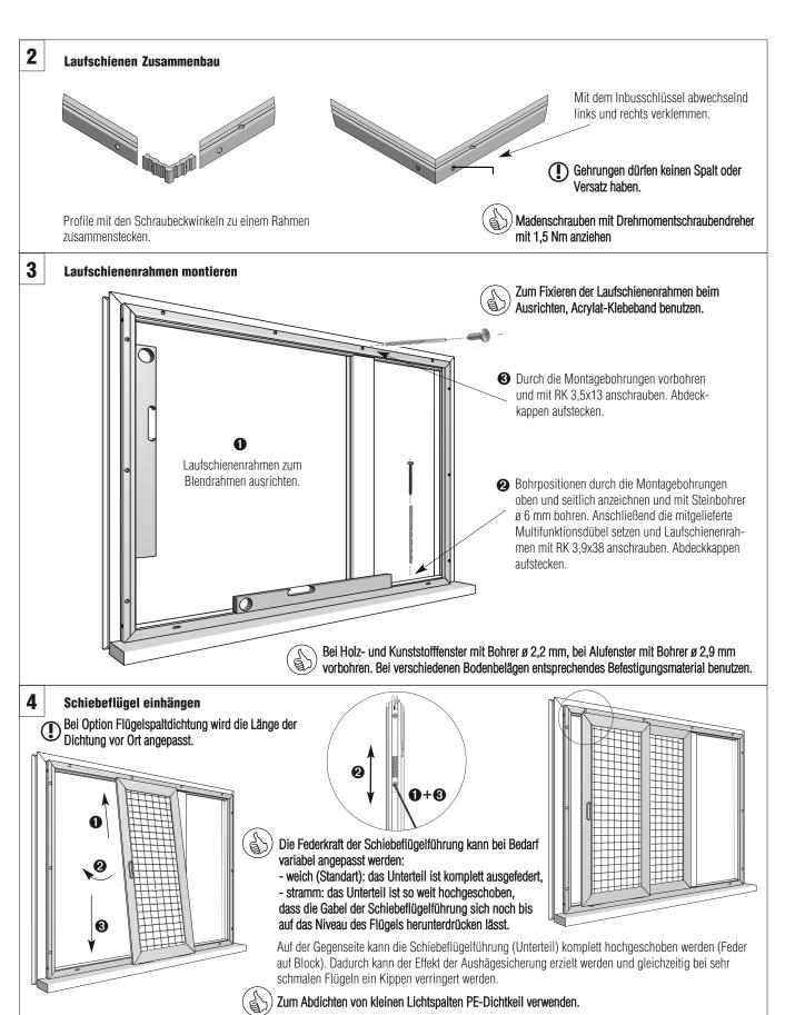
(1) Bei auf Wetterseite montierten Elementen an entsprechenden Stellen Entwässerungsbohrungen setzen.
